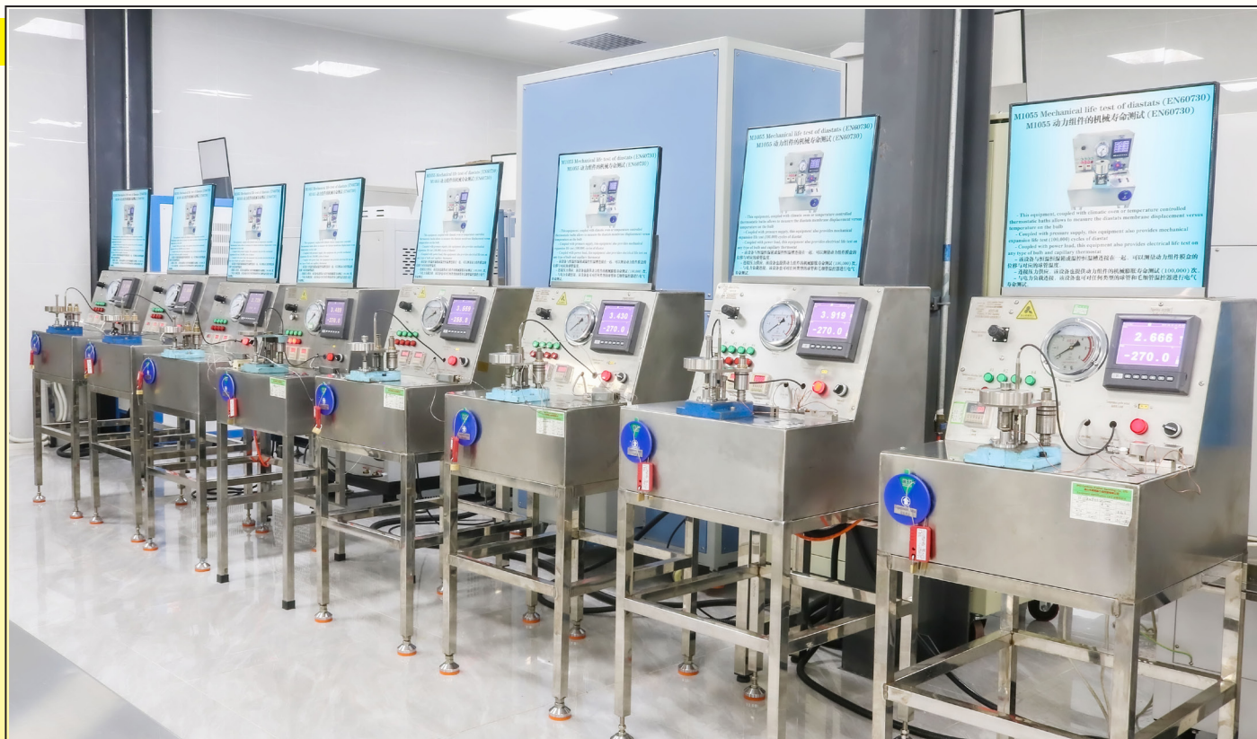
Un set di apparecchiature automatiche per test di durata meccanica diastat. Ogni apparecchiatura ha un registratore dati dei parametri di test e del numero di cicli (Laboratorio Ultimateheat).
